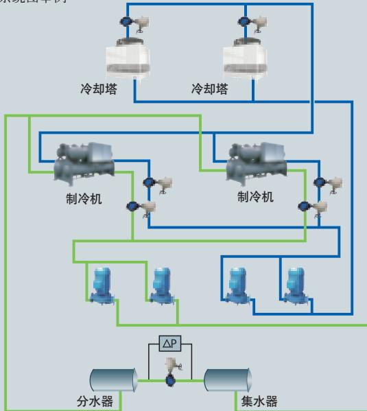
水源热泵水系统图举例
